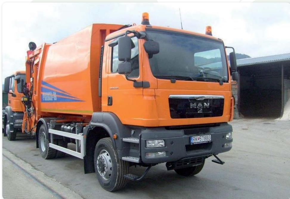
Zberové vozidlo na vyseparované komodity
