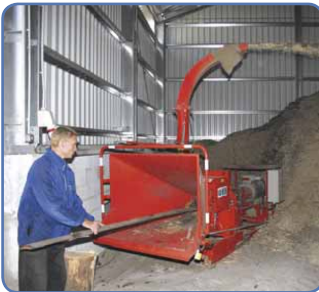
• Drvič drevnej hmoty pri výrobe biomasy
